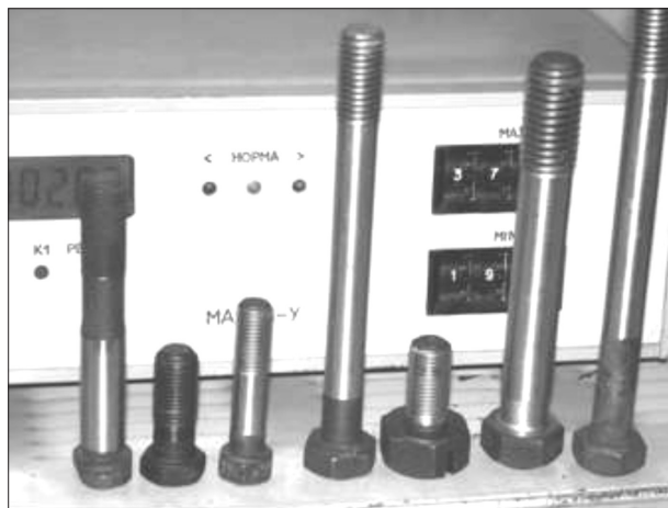
Рис.14. Внешний вид электронного блока прибора МАКСИ-У и контролируемых болтов различных типов
