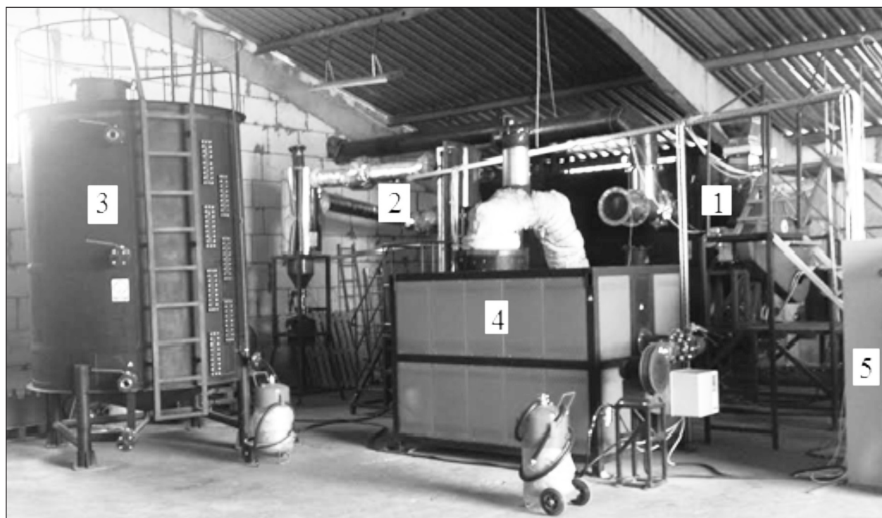
Фото 1. Шнековая установка термоллиза резиновых отходов:
