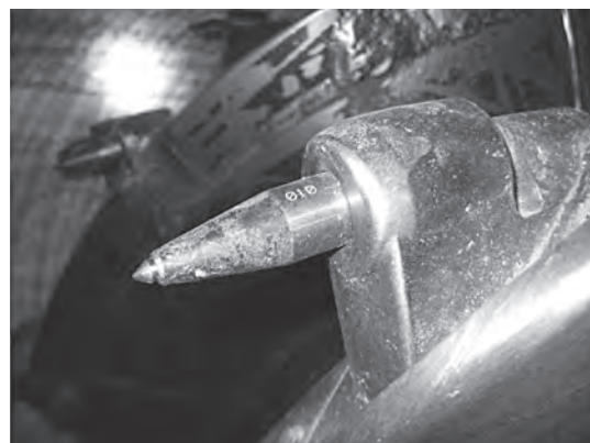
Рис. 3. Резец ротора, оснащенный режущей вставкой из наномодифицированной стали Р6М5Л (ОАО «Беларуськалий»)
