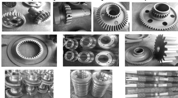
Шестерни, изготовленные в институте CMRDI для египетской компании Iron & Steel Co
