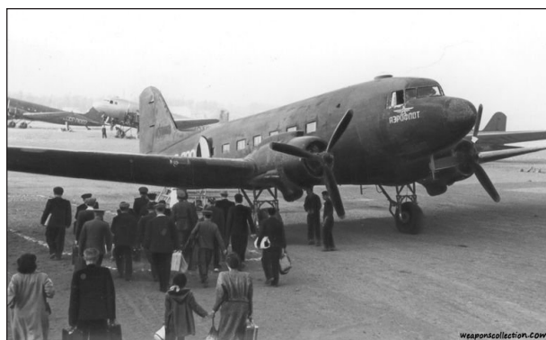
Рис. 5. Послевоенный советский «Дуглас», по-видимому, переделка десантного варианта, поскольку дверь по правому борту и небольшие коки на винтах
