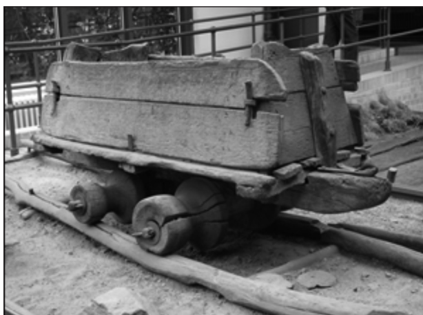
Рис. 2. Деревянная вагонетка и лежни круглого сечения, связанные между собой поперечинами – прообразами современных шпал, а на колесах тележки имеются центрирующие желоба. Экспонат хранится в Немецком техническом музее
