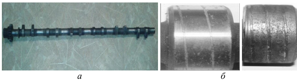
Рисунок 1 – Распределительный вал 150.03.022-1 дизель-генератора 6ЧН 12/14 (а) и примеры участков распределительных валов ДГ с покрытиями дискретной структуры (б), полученными электроконтактным методом
