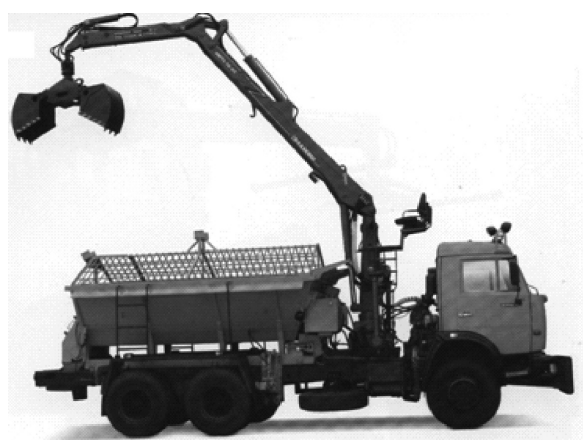
Рис. 3. Машина, совмещающая выполнение операций транспортировки, распределения песчано-соляной смеси и ее погрузки
