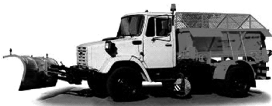
Рис. 2. Машина для распределения противогололедных материалов
