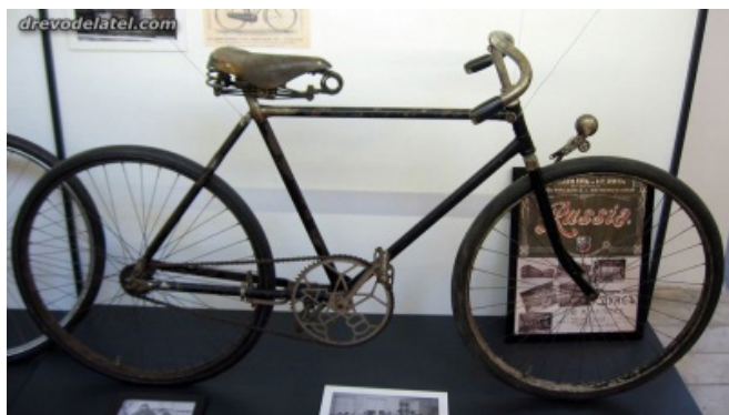
Дукс «Специальный — BSA». Россия, 1909 г. Лёгкий дорожный велосипед с необычной конструкцией педального тормоза. Изготовлен фабрикой «Дукс» с использованием комплектующих английской фирмы BSA.
