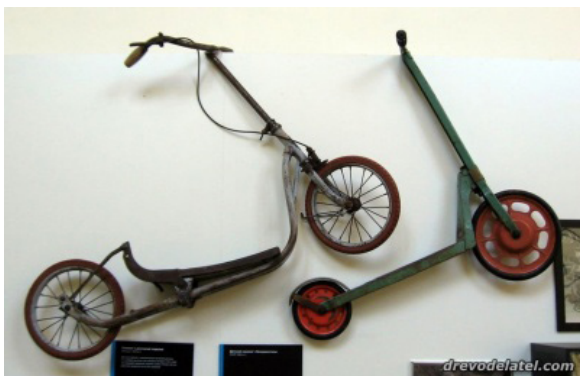
Слева самокат с разгонной педалью. Франция, 1920-е гг. Детский самокат с механической системой разгона. Он снабжён рычагом, при нажатии которого тяга с рейкой передаёт вращение заднему колесу. Такому нестандартному решению почти нет аналогов. Справа детский самокат «Запорожсталь» СССР, 1960-е гг.
