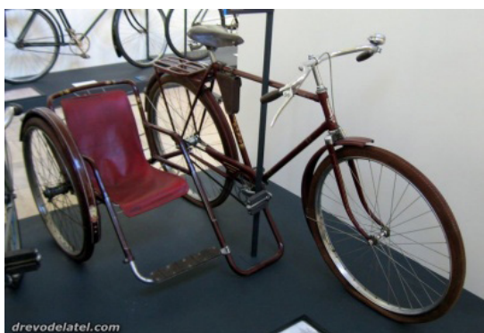
ГАЗ «Прогресс» В-110. СССР, 1954 г. Один из самых массовых дорожных велосипедов СССР. К велосипеду прикреплена боковая коляска, в которой можно было перевозить детей.
