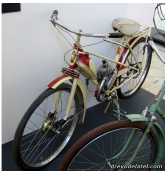
LV3, Мотовелосипед В-902. СССР (Львов), 1958 г. Такие мопеды начали производить на Львовском велозаводе в 1950-е годы. Двигатель имел мощность в 1 лошадиную силу, но зато потреблял только 1 литр бензина на 100 километров, развивая скорость до 40 километров в час.
