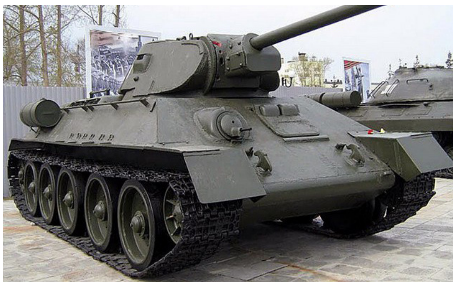
Танк Т-34-76, который выпускался советской промышленностью с 1940 по 1944 год. Оснащен 76-миллиметровым орудием
