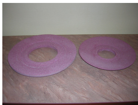
Рис. 1. Шлифовальные круги из хромистого корунда: а – тарельчатые круги для станка «MAAG», б – конический круг для станка «Niles»-«ZSTZ»
