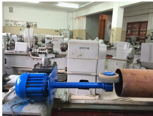
Рис. 1. Схема обработки отверстия в цилиндре
