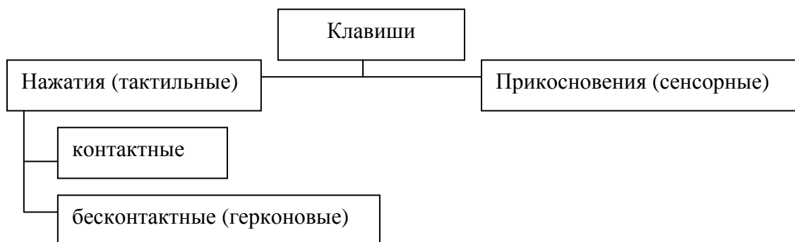
Рис. 10.1. Разновидности клавиш по принципу действия
