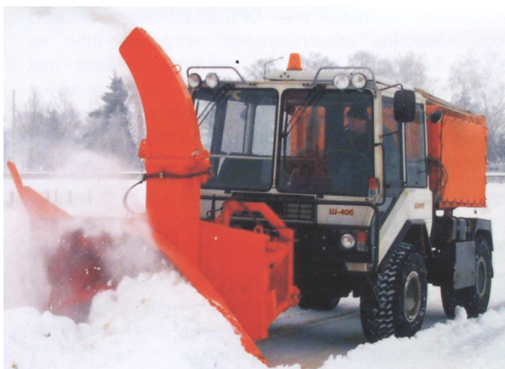
Рис. 8. Снегоочиститель роторный ОРС-20.01
