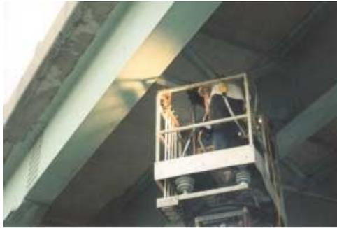
Рисунок 5.3 - Тепловой контроль узла соединения поперечной связевой рамы со стенкой стальной балки автодорожного моста (с использованием подъемника) [251]
