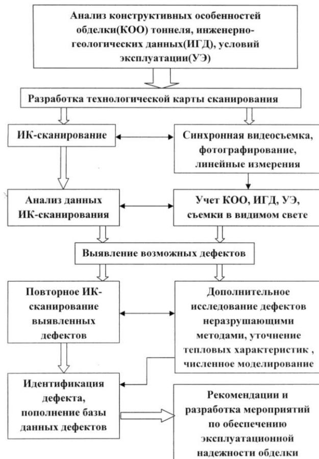
Рисунок 5.5 - Блок-схема ИК-сканирования обделки тоннеля
