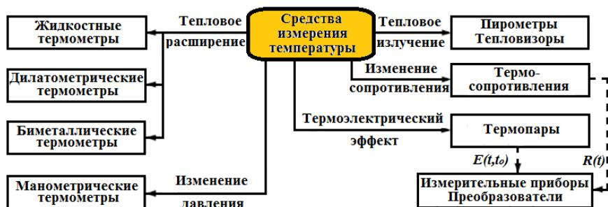
Рисунок 1.2 – Классификация средств измерения температуры
