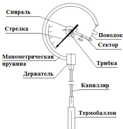
Рисунок 1.4 – Схема манометрического термометра
