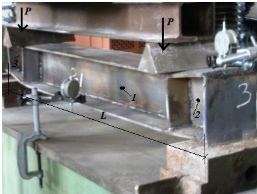
Рис.4.21- Вид экспериментальной балки в процессе нагружения
