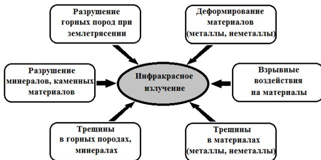
Рисунок 2.8 – Инфракрасное излучение при различных видах механических воздействий
