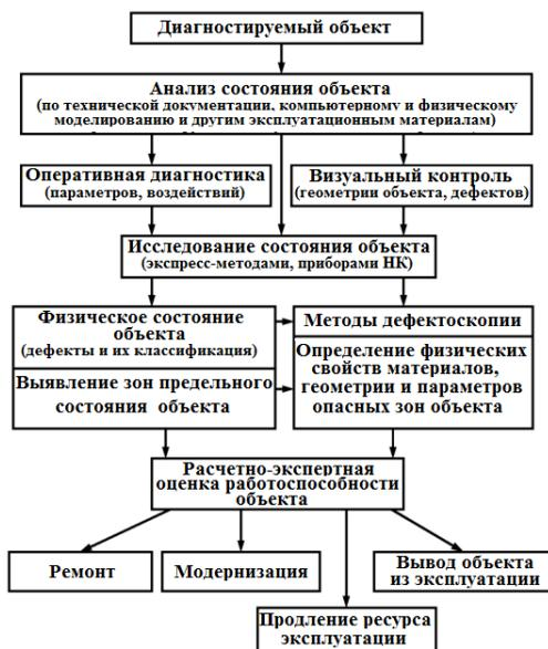
Рисунок 4.1 – Технологическая схема работ по диагностированию и оценке работоспособности объектов
