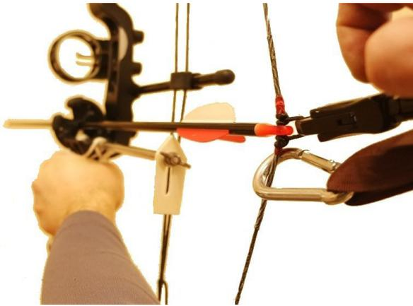
Рис. 10. Определение траектории толчка стрелы по контрольной рейке
