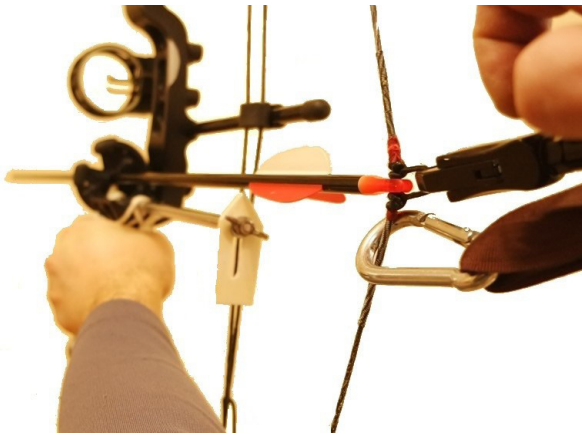
Рис. 10. Определение траектории толчка стрелы по контрольной рейке
