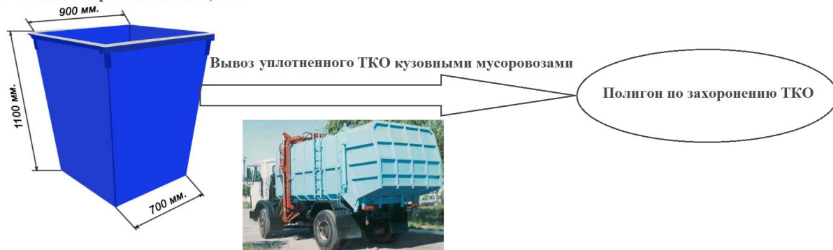
Рис. 4. Одноэтапная система сбора и транспортирования ТКО
