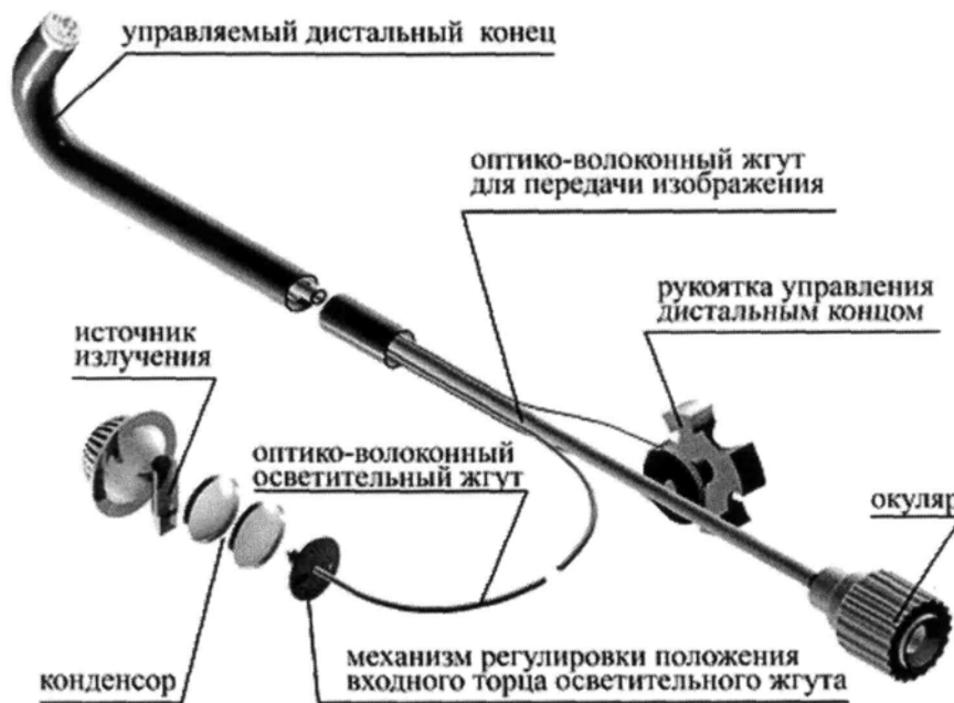
Рис. 6.25. Оптико-механическая схема эндоскопа
