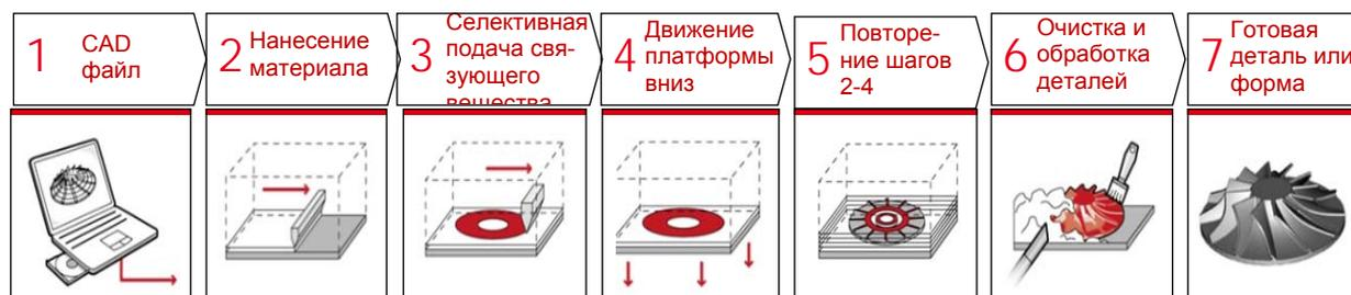
Рисунок 1 – Схема процесса 3D-печати литейных стержней
