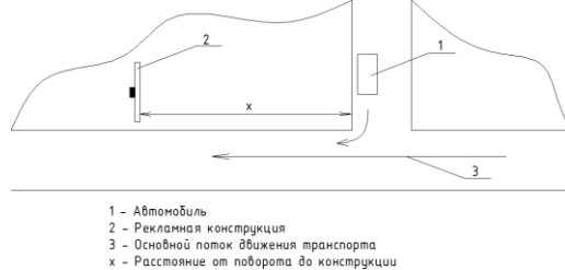
Рисунок 1 – Схема движения автомобиля и расположение рекламной конструкции
