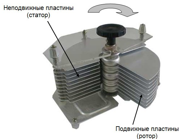
Рисунок 2 – Емкостный преобразователь углового положения (конденсатор переменной емкости)
