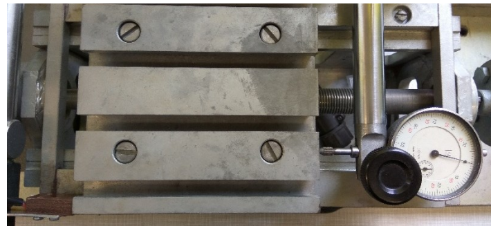
Рисунок 2 – Установка датчика Холла и ИЧ-10
