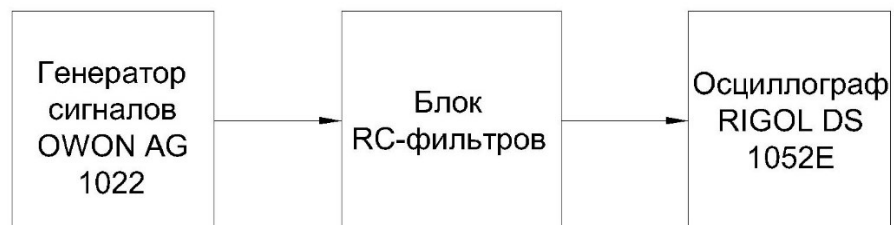
Рисунок 14 – Структура модуля контроля линейного перемещения
