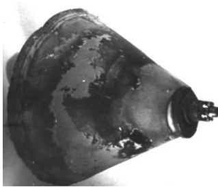
Рис. 2 – Фотографии конструкции конического экрана при исследовании равномерности осаждения покрытия по толщине на основе
