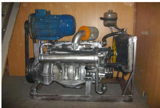
Рис. 2 – Компрессор, полученный из двигателя
