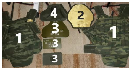
1 – чехол; 2 – арамидная плита; 3 – бронеплиты; 4 – амортизирующий подпор. Рис. 2 – Комплект бронезащиты
