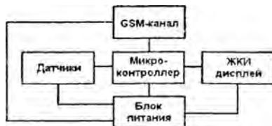
Рисунок 1 – Структурная схема системы контроля метеорологических условий с передачей по GSM-каналу
