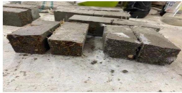
Рис. 4. Вид в разрезе моделируемого образца балки
