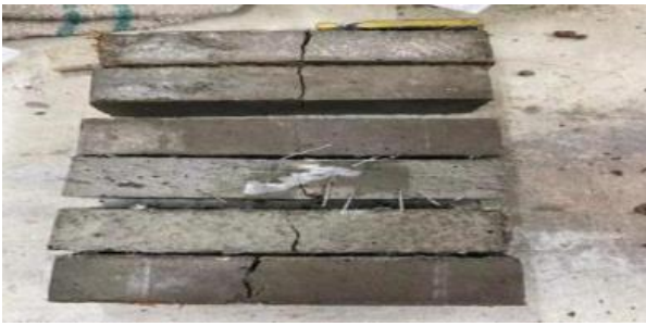
Рис. 3. Силовое разрушение моделируемого образца балки
