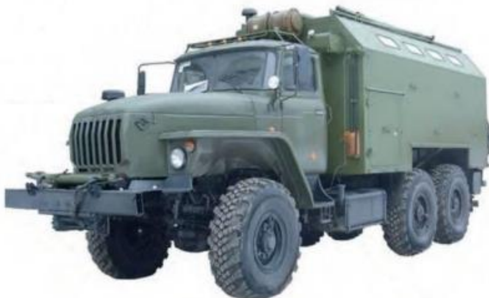
Рисунок 4 – Мастерская ремонта инженерного вооружения МРИВ-М (РФ)
