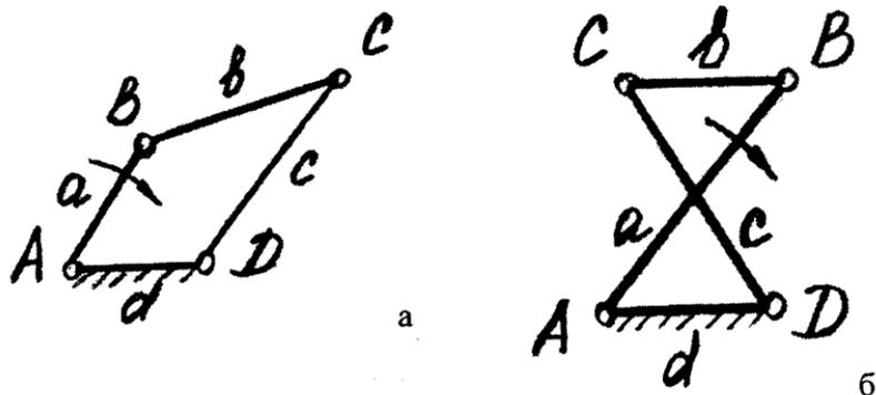
Рис. 3. Шарнирные четырехзвенники с полнооборотными кривошипами и шатуном:
