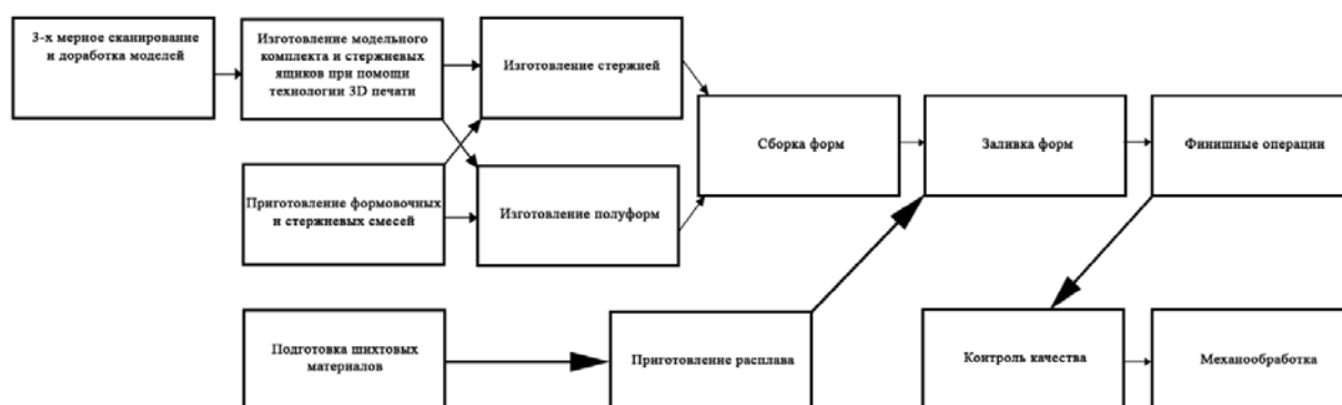
Рисунок 2 – Схема технологического процесса с внедрением технологий 3-х мерного сканирования и печати модельного комплекта и стержневых ящиков.
