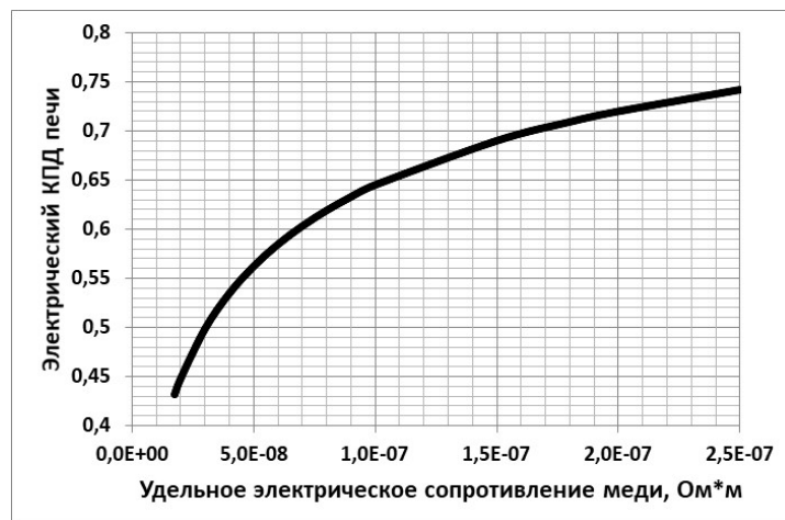
Рисунок 2 – Зависимость электрического КПД индукционной тигельной печи от удельного электрического сопротивления меди
