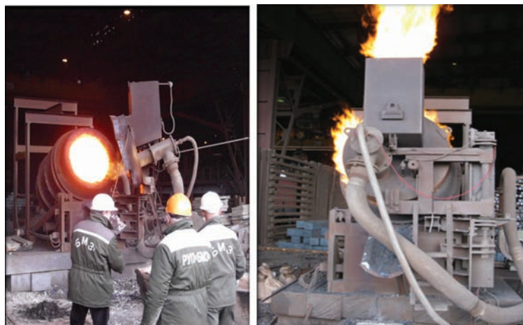
Рис. 8. Опытно-экспериментальная РНП для переработки окалины
