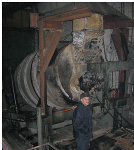
Рис. 2. 3-тонная РНП для выплавки свинца («Авангард-Юнион», г. Владимир)
