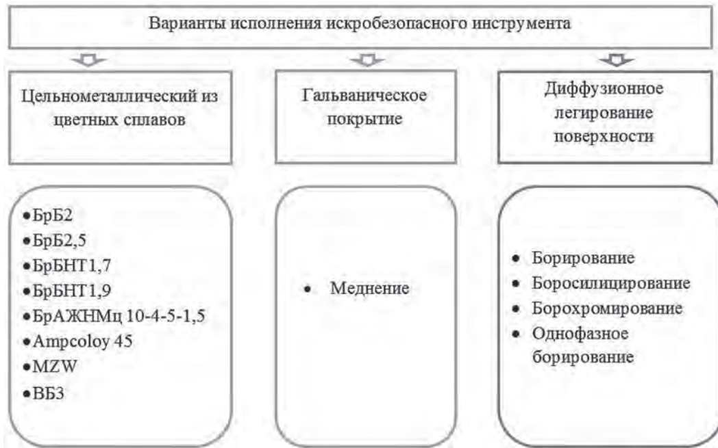
Рис. 1. Блок-схема вариантов исполнения искробезопасного инструмента
