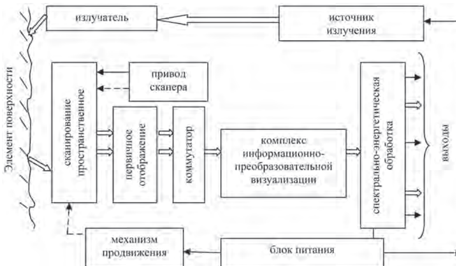
Рис. 2. Структура первичных преобразований в системе адаптивного сканирования с локальными связями: ⇔ – оптические; → – электрические; --- – механические
