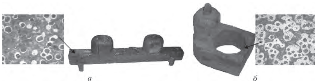
Рис. 1. Внешний вид и микроструктура отливки «Силовая тяга» (а) и отливки «Подушка» (б) из ВЧШГ
