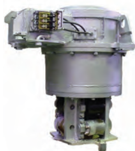
Рис. 1. Кристаллизатор электромагнитный перемешиватель для литья заготовок сечением от 250 до 360 мм
