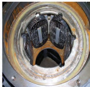
Рис. 1. Кристаллизатор электромагнитный перемешиватель для литья заготовок сечением от 250 до 360 мм
