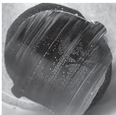
Проба № 4 после вылеживания арматуры 5 сут
