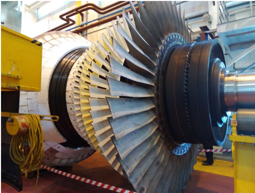
Рисунок 3 – Побежалость материала лопаток
