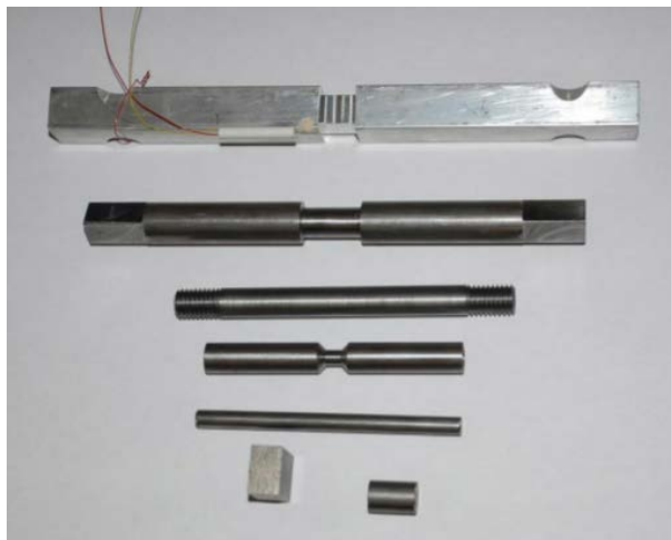
Рисунок 2 – Образцы для испытаний на комплексе Gleeble
