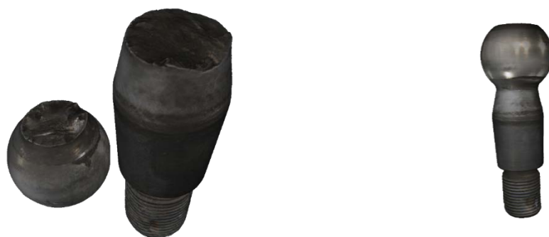
Рисунок 1 – Виртуальные 3D-модели двух частей разрушенной детали «шаровой палец» (а); создание изображения 3D-модели детали «шаровой палец» путем виртуальной реконструкции разделенных частей (б)
