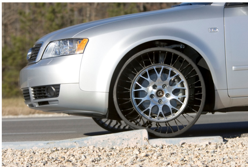
Рисунок 2 – Изменение формы безвоздушного колеса при наезде на неровность
