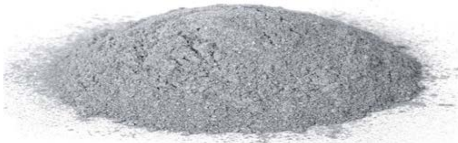
Рисунок 4 – «Атомизированный» порошок для процессов 3D-печати металлом
