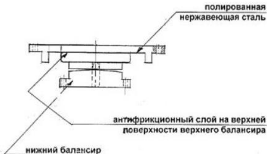
Рисунок 2 – Тангенциальная скользящая опорная часть
