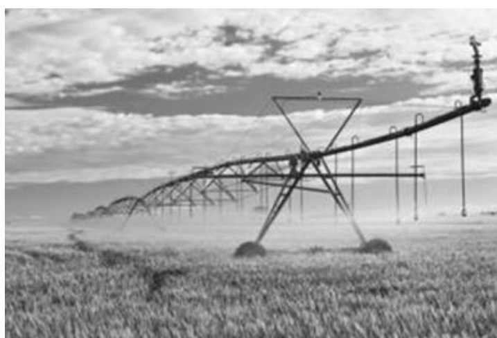
Рисунок 4 – Дождевальная установка 360 А
