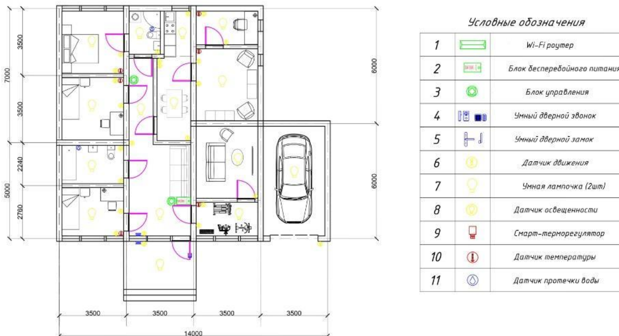
Рисунок 3 – План модульного дома с размещением элементов системы «homeMODE» (Источник: собственная разработка авторов)
