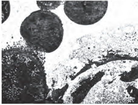
Рис. 4. Микроструктура композиционного материала после лазерной обработки из второй серии. Травлено, \times 100
