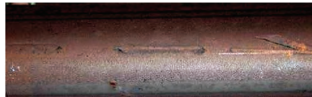
Рис. 8. Внешний вид дефектов, выявленных на готовой трубе
