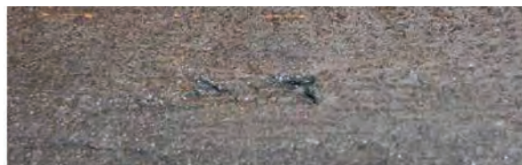
Рис. 4. Внешний вид дефектов на поверхности горячекатаной заготовки
