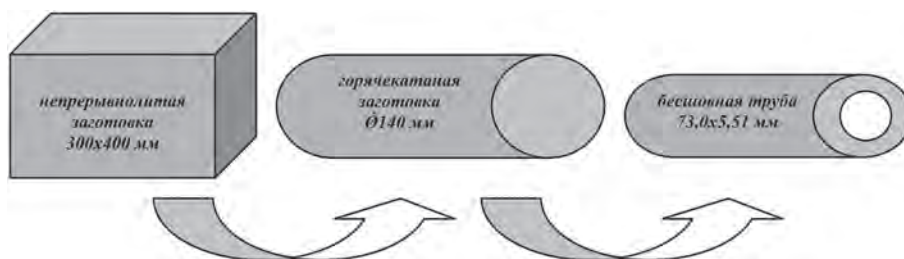
Рис. 1. Технологическая схема производства бесшовной трубы из непрерывнолитой заготовки
