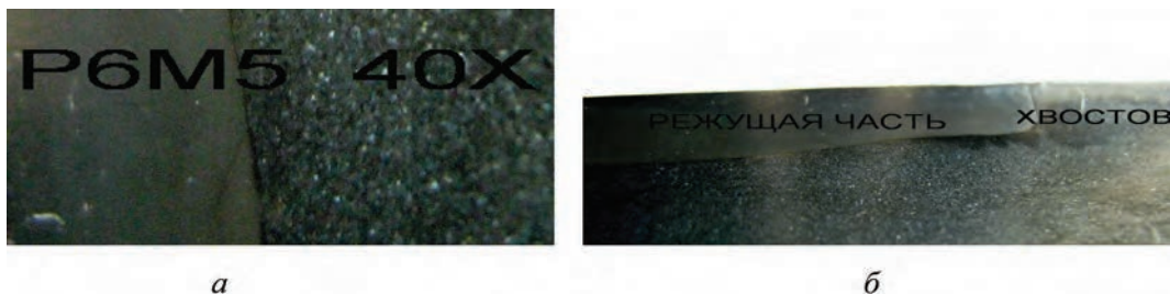
Рис. 10. Зоны измерения микротвердости в продольном сечении биметаллической заготовки: а – поперек заготовки от края к центру; б – сталь 40Х в центре заготовки в направлении от режущей части к хвостовику. а – \times 5 ; б – \times 3
