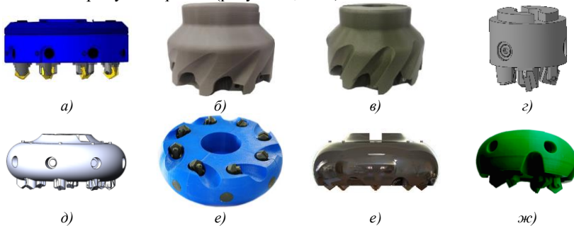
Рисунок 7. – Экспериментальные конструкции сборных торцовых фрез в форме диска (а), диска и конуса (б и в), цилиндра (г) и тора (д–ж)
