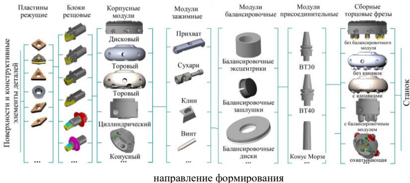
Рисунок 1. – Конструктивные элементы сборных торцовых фрез
