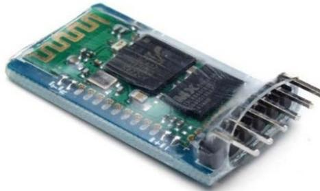
Рис. 10 – Модуль Bluetooth HC-05
