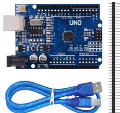
Рис. 9 – Отладочная плата Arduino UNO R3 SMD CH340
