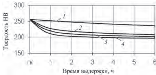
Рис. 5. Влияние длительности изотермической выдержки отжига при температурах: 550 °C (1); 600 °C (2); 650 °C (3); 680 °C (4) на снижение твердости хромомолибденовой стали
