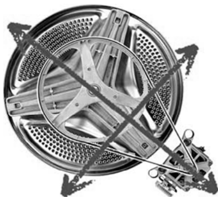
Рис. 1.3. Ременная передача вращения от электродвигателя к барабану
