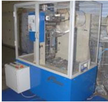
Рис. 7.6 – Внешний вид целлофанатора для упаковки штучных продуктов
