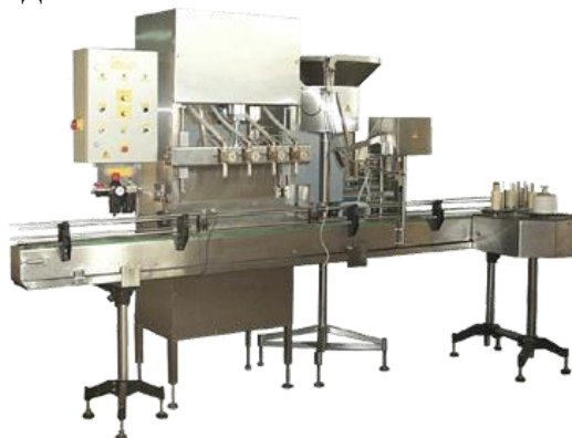
Рис. 6.3 – Линия розлива чистой воды
