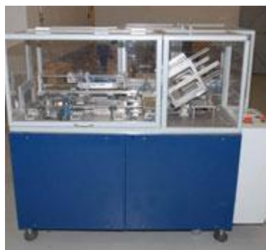
Рис. 7.5 – Внешний вид автомата картонного для упаковки штучных продуктов
