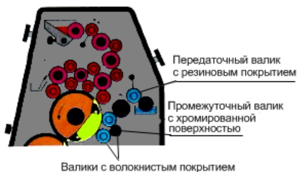
Рис. 8.6 Увлажняющий аппарат с передаточным валиком
