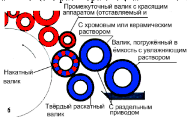
Рис.8.7 Плёночный увлажняющий аппарат офсетной машины
