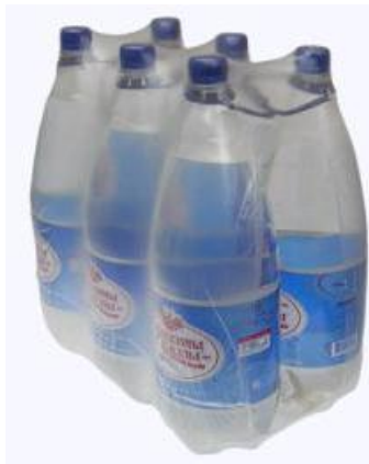
Рис. 6.4 – Групповая упаковка воды в термоусадочную пленку
