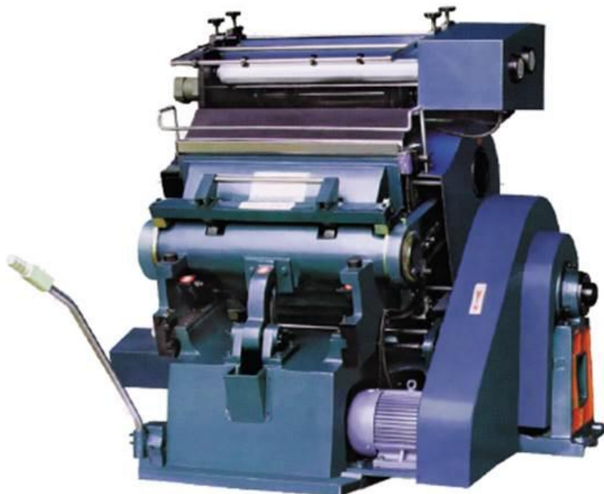
Рис. 11.1 Позолотный штанцевальный пресс с программным управлением типа CNC ТУМВ-750
