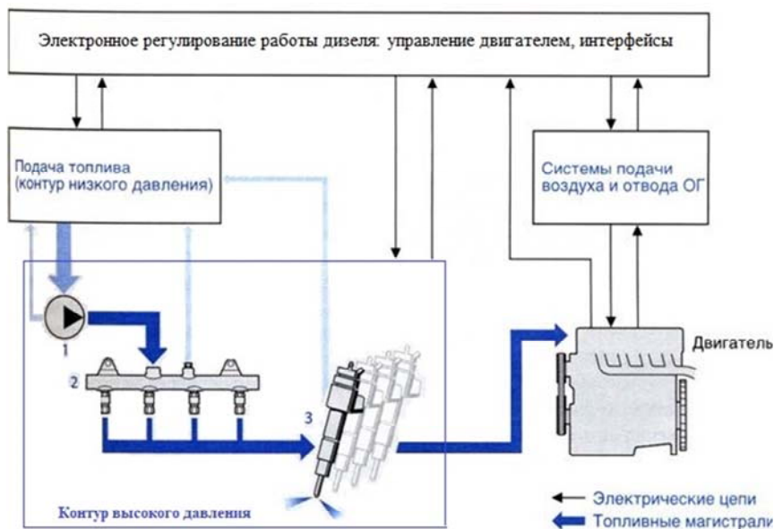
Рис. 4.29. Принципиальная схема управления работой дизеля с аккумуляторной системой впрыска:
