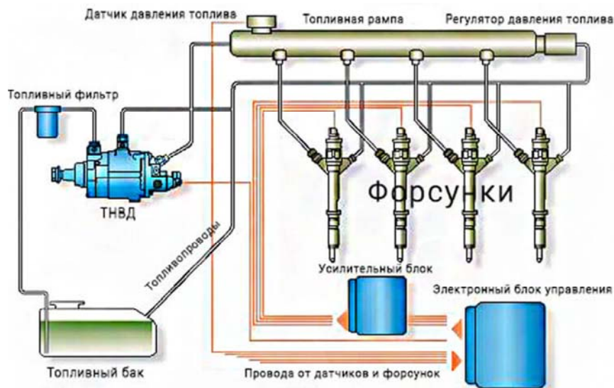
Рис. 4.28. Схема системы впрыска Common Rail
