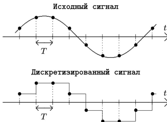
Рисунок 7 – Перевод непрерывного сигнала в дискретный
