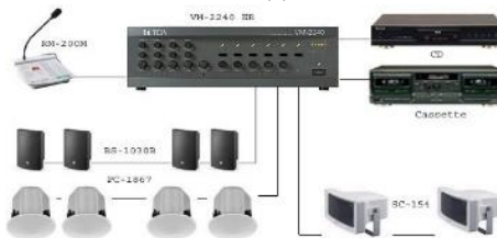
Рис. 1. Схема системы фонового озвучивания
