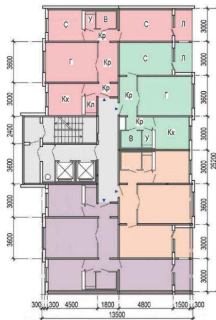
Рис. 4. Схематичный план типового этажа 12-этажного жилого здания серии М111-90: В – ванная; Г – гостиная; Кл – кладовая; Кр – коридор; Кх – кухня; Л – лоджия; С – спальня; У – уборная
